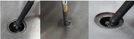
図8 各種プレートの電極洗浄の様子 左: SP 用プレート 中:小片用プレート 右:今回開発治具(アタッチメント)を付けた通常プレート(φ13 mm)
