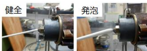
図 2 健全なストランドと発泡したストランド
