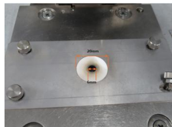
4. 通常プレートにアタッチメントを装着した状態(図は \phi 6\text{ mm} )
