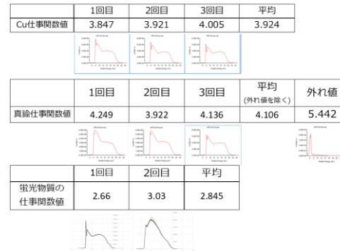
図 3 UPS 分析による各種試料の仕事関数値及びそのスペクトル
