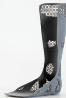
左：五軸切削による後加工実験モデルの造形／右：トポロジー最適化設計した短下肢装具の造形
