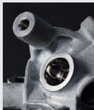
左：五軸切削による後加工実験モデルの造形／右：トポロジー最適化設計した短下肢装具の造形
