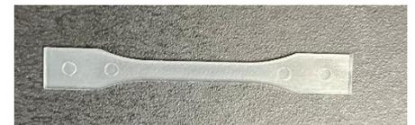
作製したダンベル試験片
