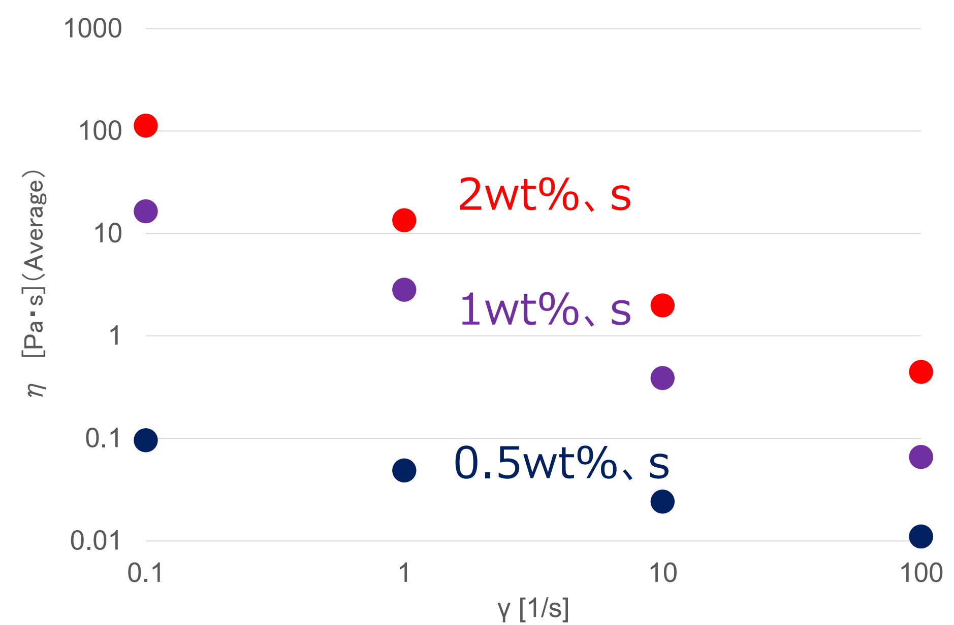
図3 粘度( \eta )のせん断速度・濃度依存性(s)
