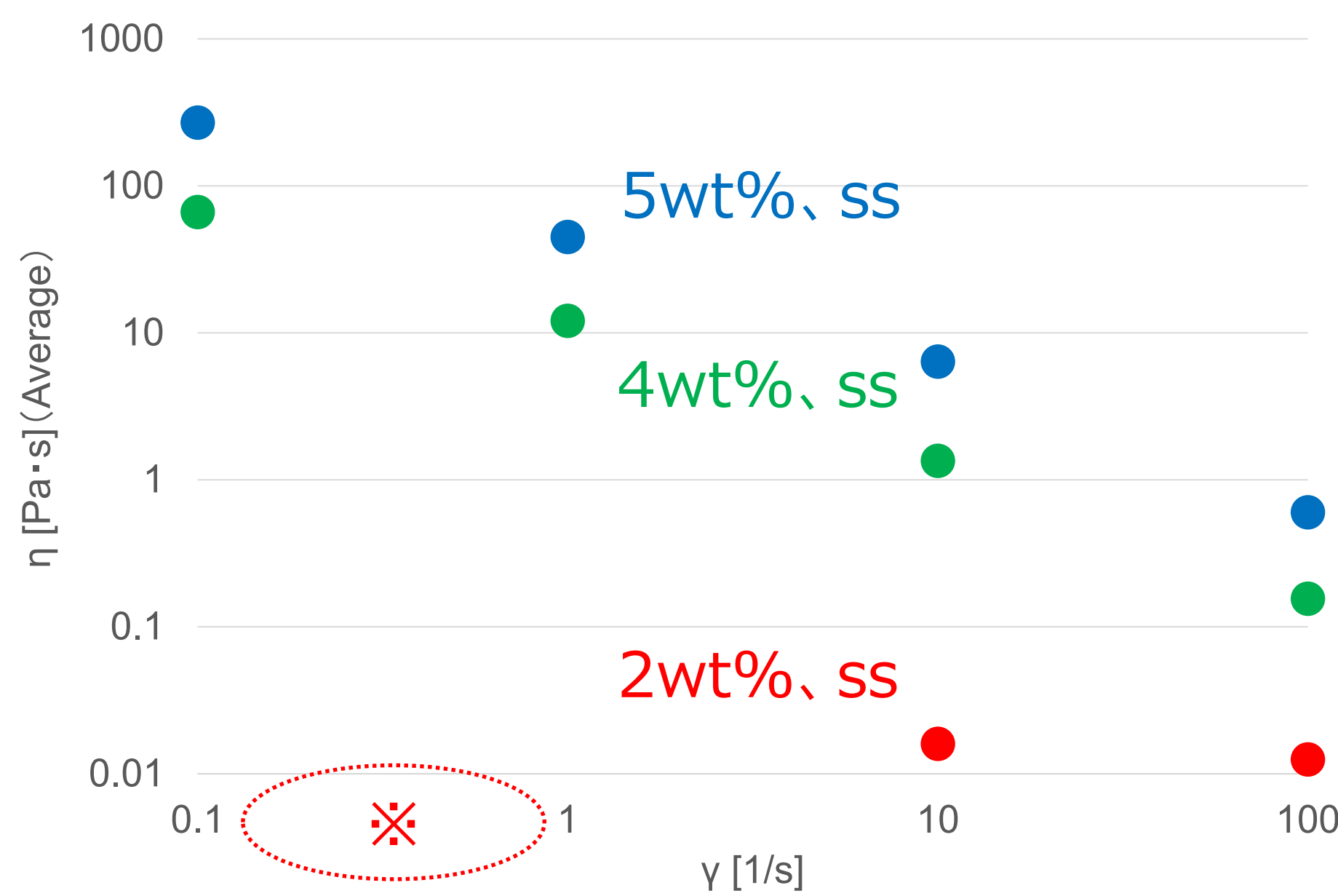
図2 粘度( \eta )のせん断速度・濃度依存性(ss) ※ 2wt%、0.1/1s -1 では粘度を捉えられていない
