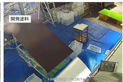
図5 凍結→融解による 滑雪現象の再現
