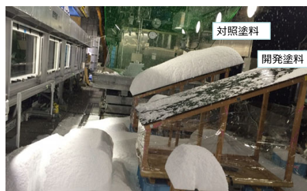
図4 気温上昇がない状態で 滑雪現象の再現
