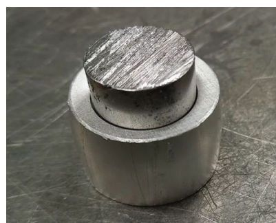
図1 S45CとA1070の接合写真
