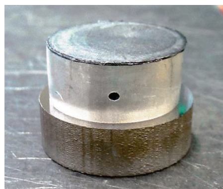
図8 SUS316LとA5052の接合写真
