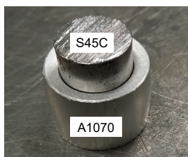
温度:450℃ 加圧力:1 ton 接合時間:360 min 真空度:10 mPa
