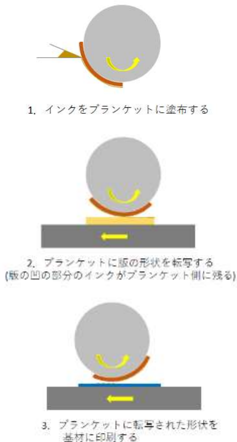
図2 反転オフセット印刷機の印刷工程の概要
