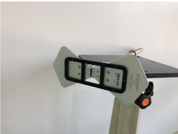
図6 近接照射試験用アンテナ
