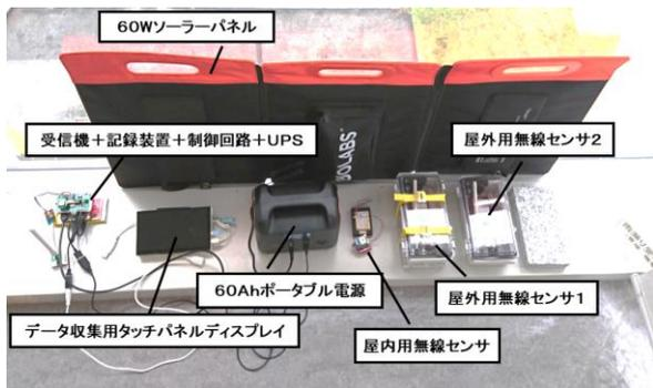
図5 簡易自立電源を用いたデータ記録装置
