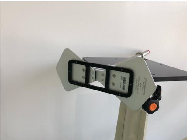
図6 近接照射試験用アンテナ
