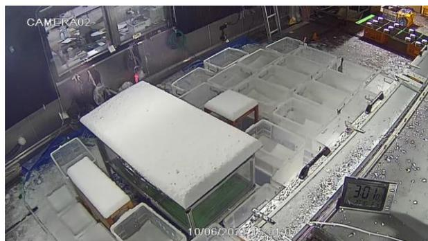
図6 一液シリコン塗料の積雪状況(Stage1)
