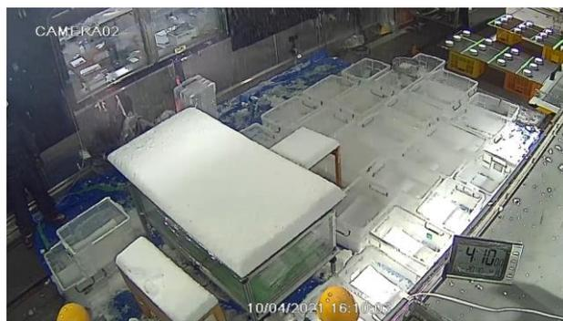
図5 ワックス添加塗料の積雪状況(Stage1)
