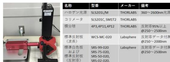
図6 測定精度評価システムの外観および構成部品
