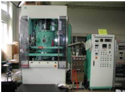
図1 パルス通電焼結装置 Dr.SinterSPS7.40
