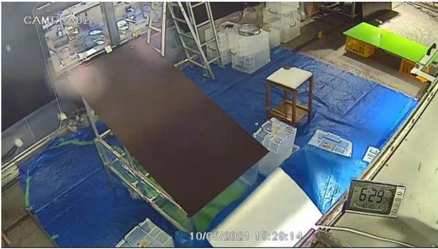
図7 ワックス添加塗料の滑雪状況(Stage4)
