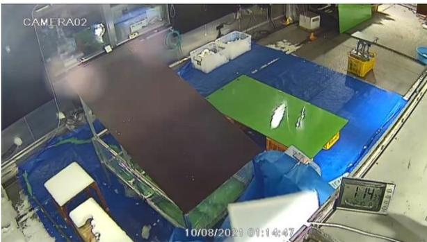
図8 一液シリコン塗料の滑雪状況(Stage4)
