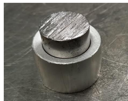
図1 S45CとA1070の接合写真
