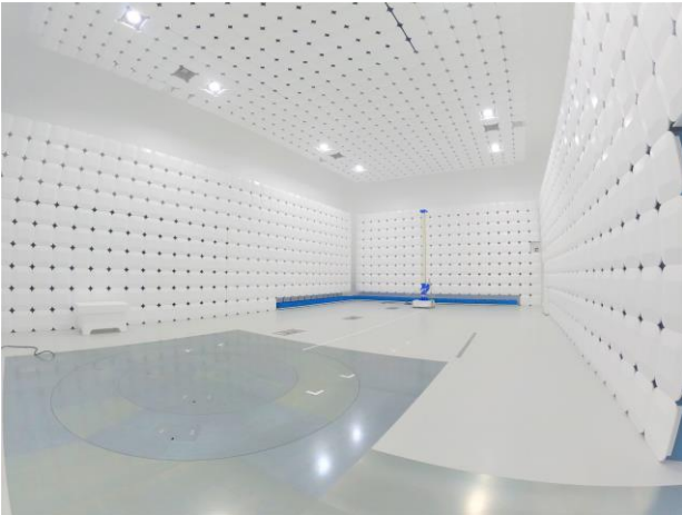
図1 EMC総合試験棟に導入した10m法電波暗室
