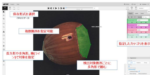
図 17 CVAT での作業画面：検出したい部位を多角形で囲み、画像上の座標が JSON ファイル等様々な形式で出力される。
