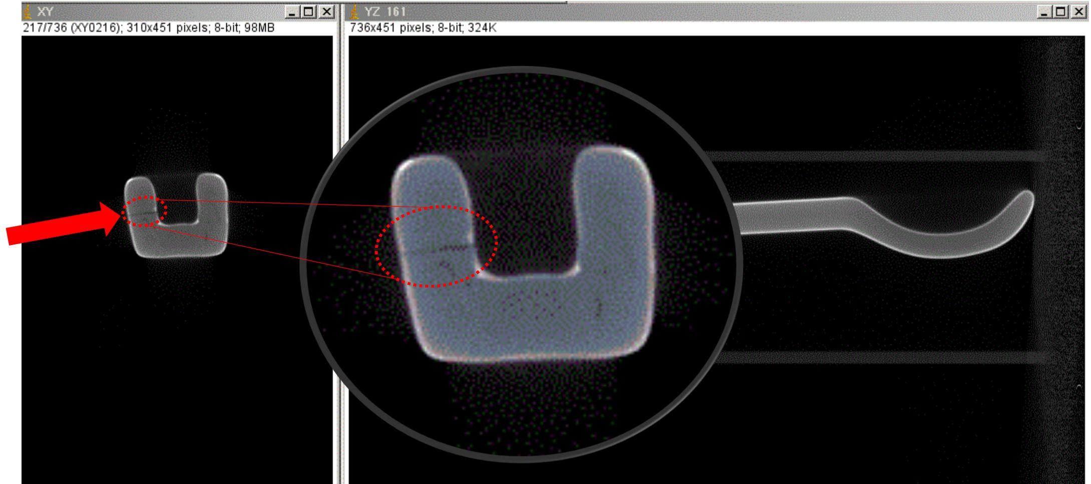
撮影条件: 管電圧 = 100Kv, 管電流 = 100 $\mu$ A
