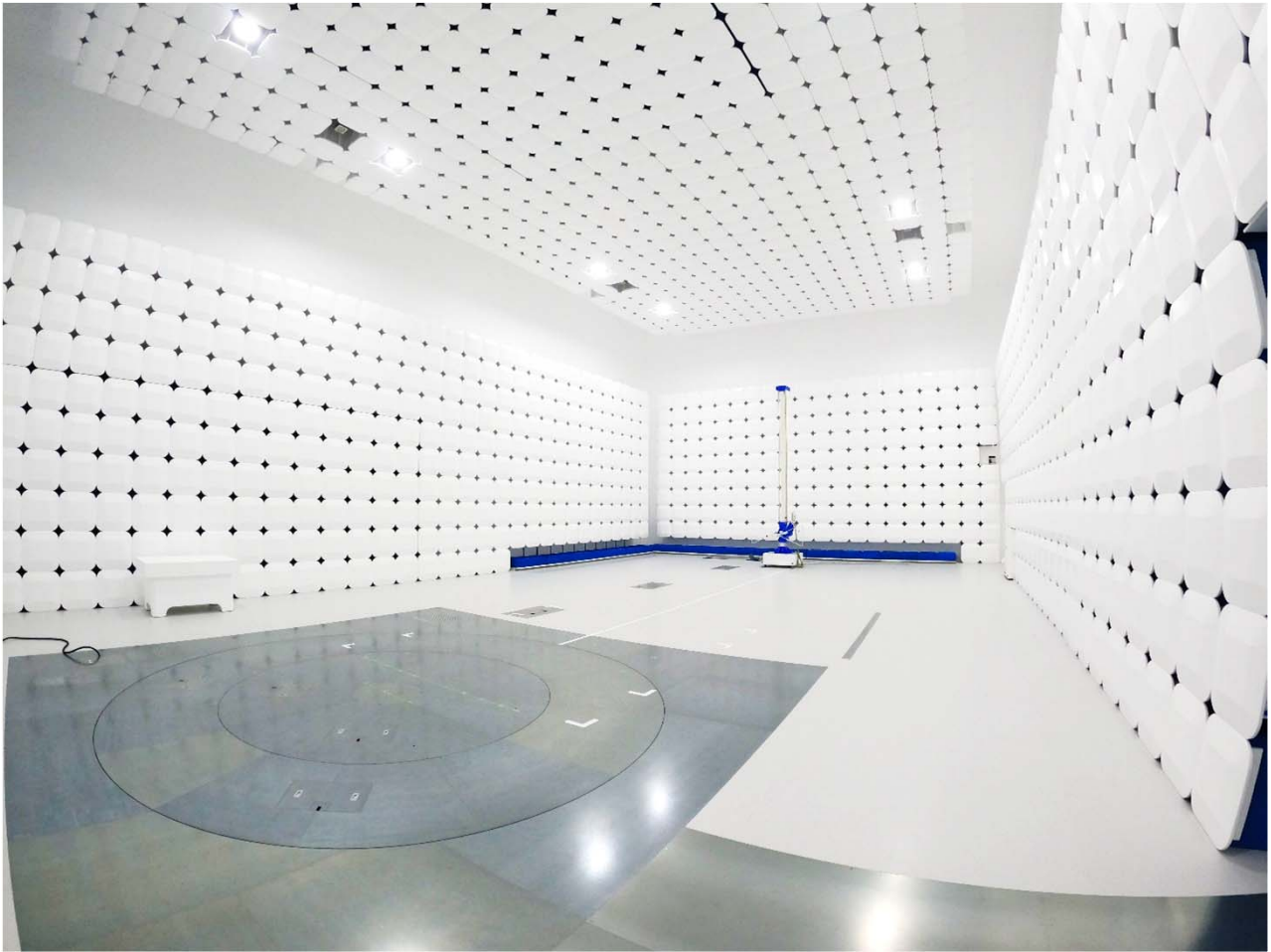
10m法電波暗室
