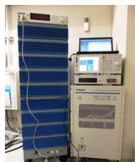
③ 高調波フリッカー 試験装置
