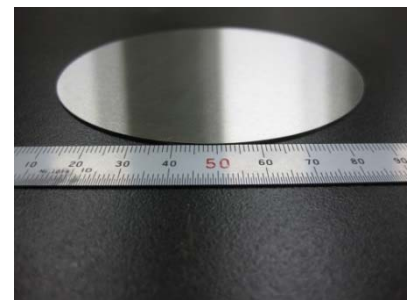
図2 研削後の SUS304 薄板
