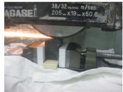
図1 CBN 砥石によるレール材料の乾式研削の様子
