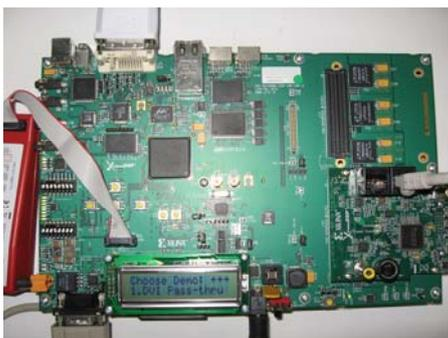
図2 FPGA評価ボード
