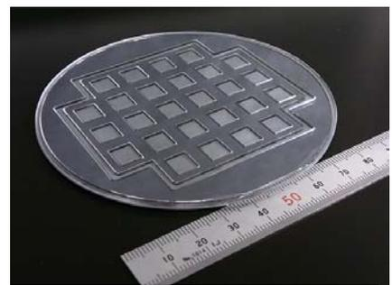
図3 COP樹脂製MEMSパッケージウェハとシリコンウェハの接合品
