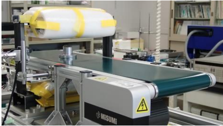
図 2-1-9 コンベヤを一体化した検査装置プロトタイプ(開口幅 250mm の小型装置)
