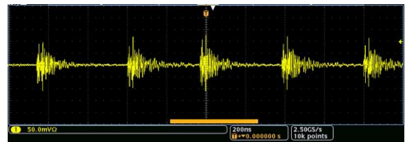
図 4-8 ホイストクレーンの放射スイッチノイズ
