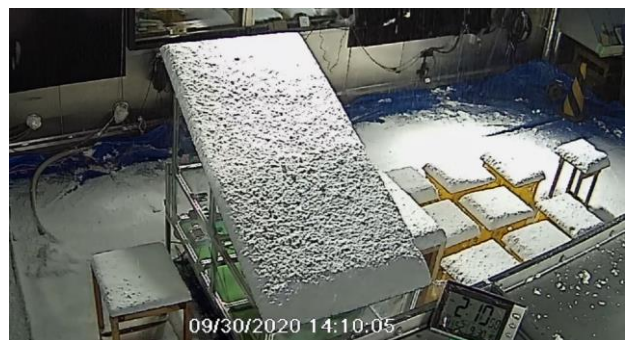
図4 一液シリコン塗料の積雪状況(Stage1)
