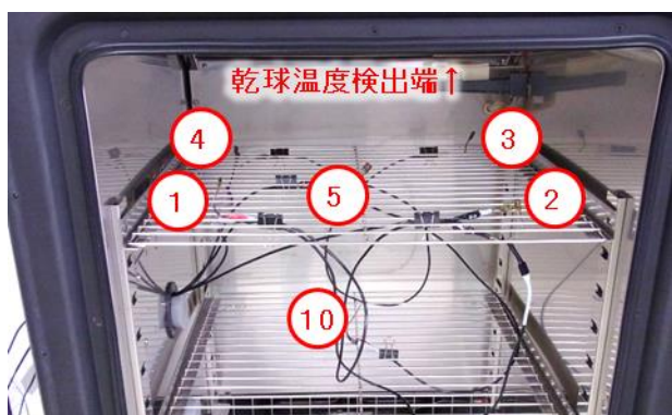
図6 槽内上段での温度センサの設置写真 (PSL-2KPH)
