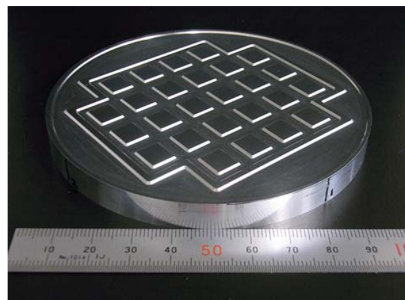
図11 MEMSパッケージウェア用モールド
