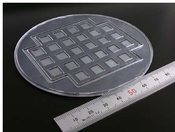
図13 COP樹脂製パッケージウェハとシリコンウェハの接合品
