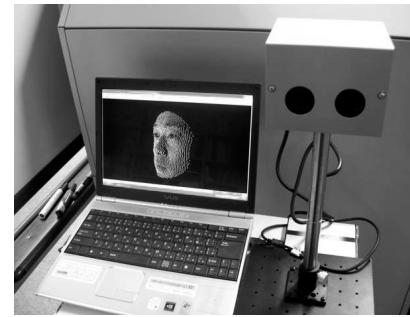
図2-5 受動型三次元形状計測システムの外観
