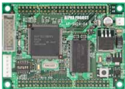
図 5 開発に使用したSH2Aマイコンボード
