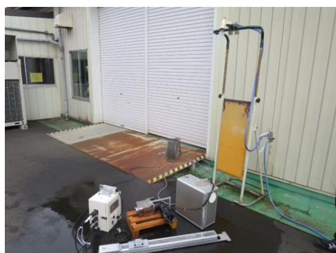
図12 電気部品の散水試験の様子
