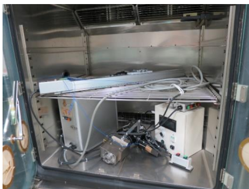
図11 恒温槽による温度サイクル試験の様子
