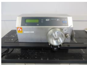
図 3 F1 印刷適正試験機 (IGT 社製)とスペック概要
