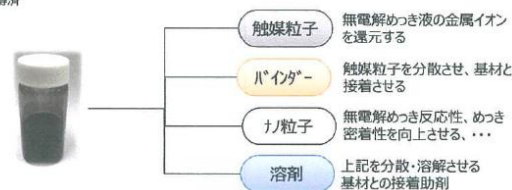
図1 めっきプライマーインクの概要
