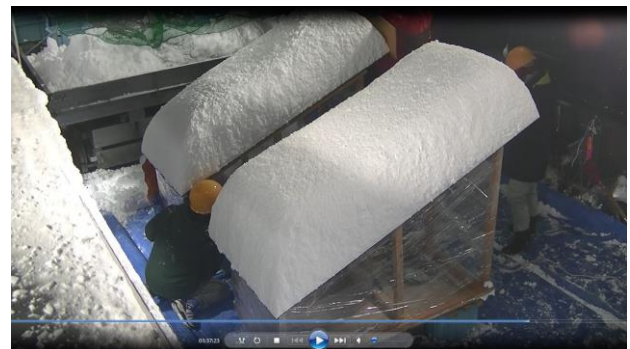
図10 最大積雪時のワックス添加塗料(奥)と一液シリコン塗料(手前)
