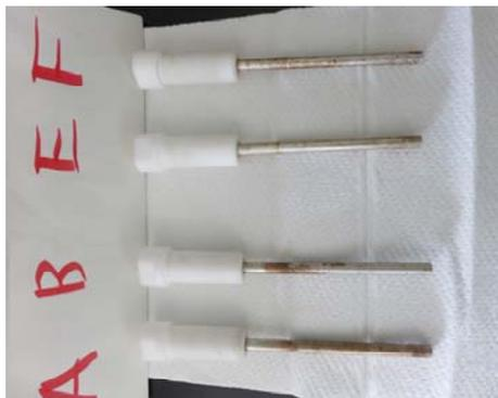
図4 テストピース(アルミニウム合金 高温側)
