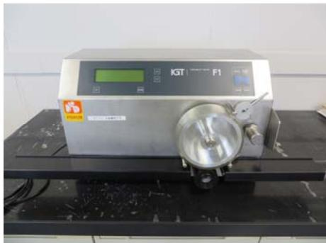
図3 F1印刷適正試験機(IGT社製)
