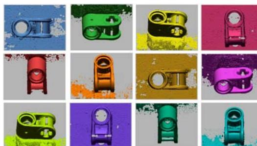
図2 12方向からの3次元画像計測データ
