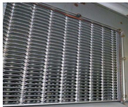
図11 開発した熱交換器内部(洗浄後)
