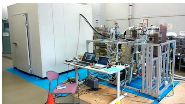
図13 ランキンサイクルを応用した未利用熱利用機器
