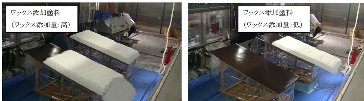
図1 二寸勾配, 降雪→融雪モード実験結果
