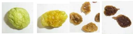
真空凍結乾燥 (FD)    マイクロ波減圧乾燥    送風乾燥 (40℃)    送風乾燥 (70℃)
