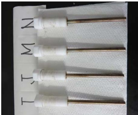
図4 テストピース(SUS304・316 高温側)
