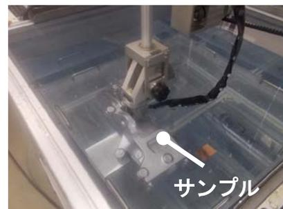
図7 アルミニウム鋳造品の探傷状況
