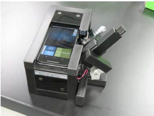
図1 携帯型接触角計
