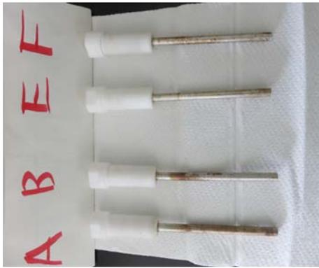
図2 テストピース(アルミ合金 高温側)
