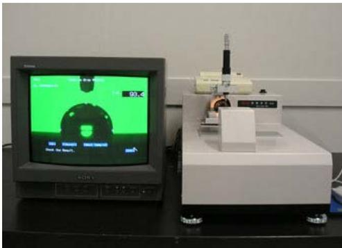
図2 机上型接触角計
