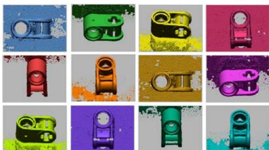
図3 12方向からの3次元画像計測データ
