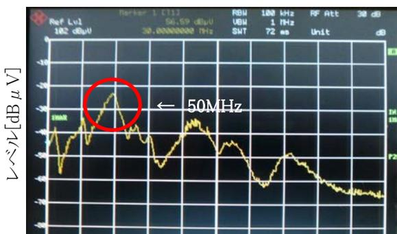
図13 サンプルの放射妨害波測定(垂直偏波)
