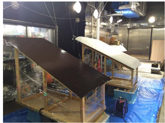
図5 -2℃から+2℃への変化(滑雪塗料, 4寸勾配)
