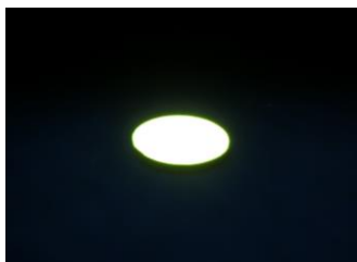
図9 Ce:GAGG セラミックス紫外線励起蛍光
