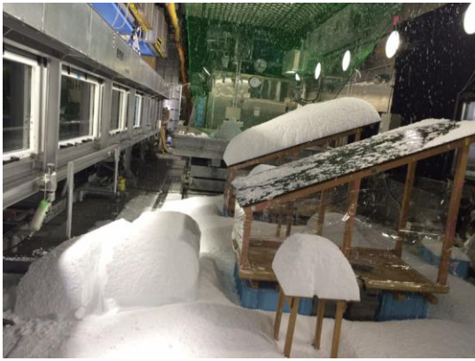
図4 4寸勾配の落雪・積雪状況(室温:-2℃)
