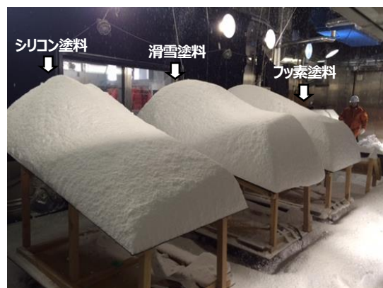
図3 2寸勾配での積雪状況(室温:-2℃)
