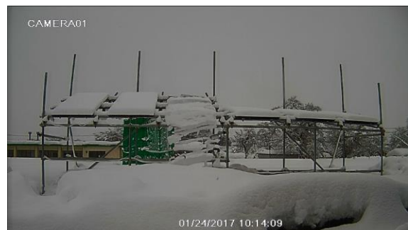
図6 2017.1.24 10:14:09, 新庄市 勾配:左3枚-4寸勾配,右3枚-2寸勾配 塗料種類:左-フッ素塗料,中-シリコン塗料,右-滑雪塗料
