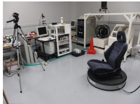
図11 自動車用シートの3次元測定の様子
