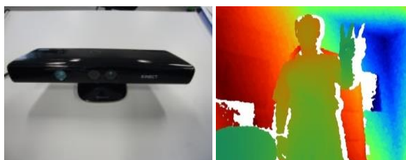
図3 赤外線パターン投影方式カメラと測定例
