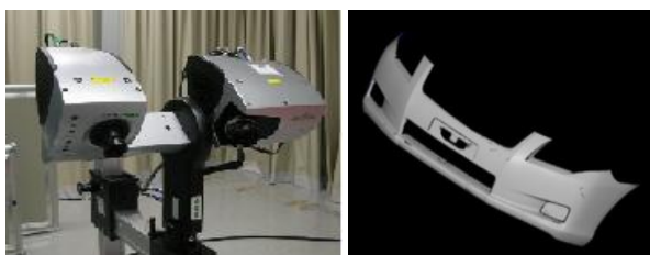
図4 3次元デジタイザと測定例
