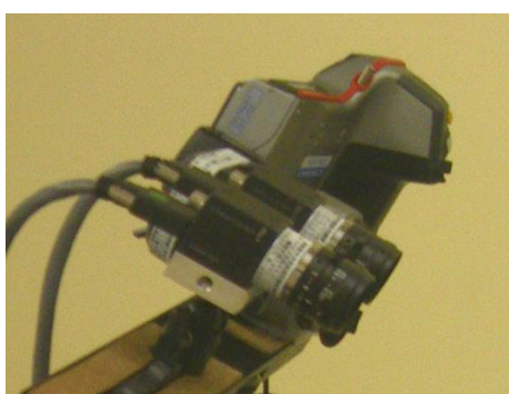
図27 試作した3次元熱画像カメラ
