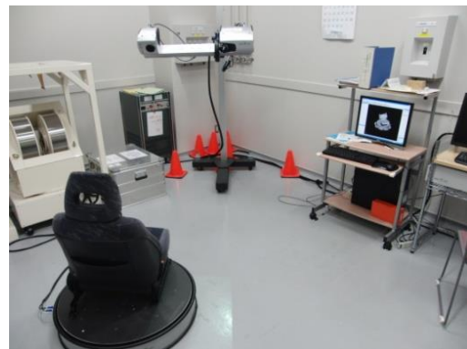
図21 3次元デジタルカメラでの測定の様子
