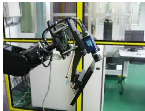
図25 試作した外観検査ロボット
