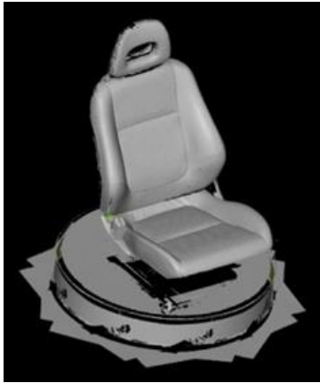
図22 3次元デジタル化での測定データ
