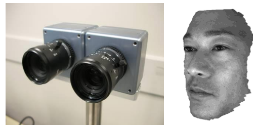
図1 ステレオビジョン方式カメラと測定例
