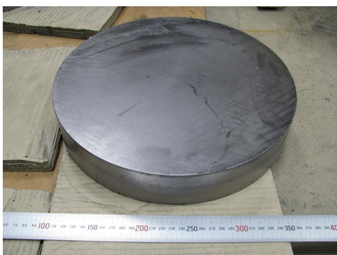
写真4 焼結体外観 (SUS316L, φ300×52mm厚)
