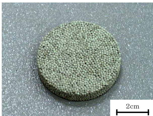
図 11 多孔質フィルター試作例 ( \phi 3mm 未満の球状成形体)
