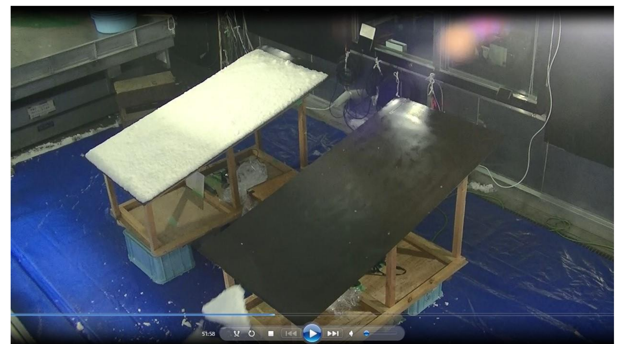
低温試験の模擬屋根板設置状況 室温 +2^{\circ}\text{C} 到達後10時間43分後の屋根用ワックス添加塗料屋根板(手前, 落雪の瞬間)。奥は対照塗料(一液シリコン塗料)屋根板で、この後15時間経過時点でも落雪しなかった。傾斜は2枚とも2寸勾配。
