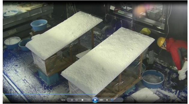
図 14 -5^{\circ}\text{C} 下最大積雪量のワックス添加塗料パネル(手前)及び一液シリコン塗料パネル(奥)
