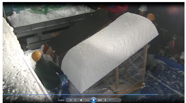
図 11 滑雪抵抗計測後のワックス添加塗料パネル表面(奥)
