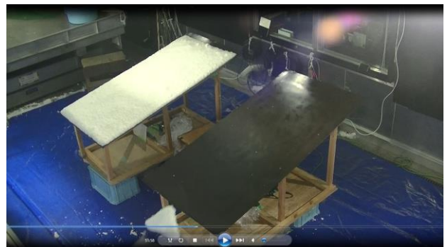
図 16 室温 +2^{\circ}\text{C} 下でのワックス添加塗料パネル(手前)の滑雪, 奥は一液シリコン塗料パネル
