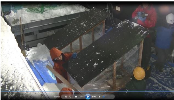
図 13 滑雪抵抗計測後の一液シリコン塗料パネル表面(手前)
