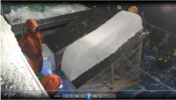
図 12 一液シリコン塗料の凍着部を除外して切り出した積雪(手前)
