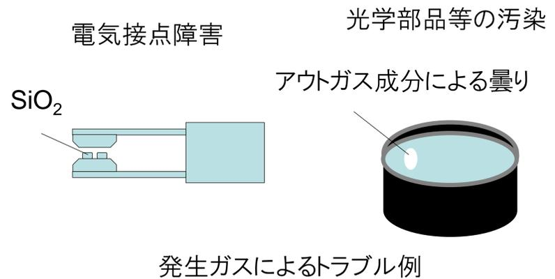
ガスクロマトグラフ質量分析計(GCMS)を用いた発生ガス分析は分析目的や、分析したい物質等によって適切な前処理方法を選択する必要があります。当センターでは①溶媒抽出法②ヘッドスペース(シリンジ)法③固相マイクロ抽出(SPME)法等の手法を用いて発生ガス分析ができます。
