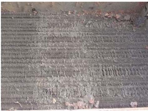
図3 低温側熱交換器内部(腐食・閉塞)
