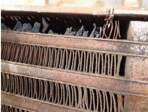
図2 高温側熱交換器内部(腐食)
