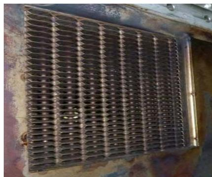
図10 開発した熱交換器内部(洗浄前)
