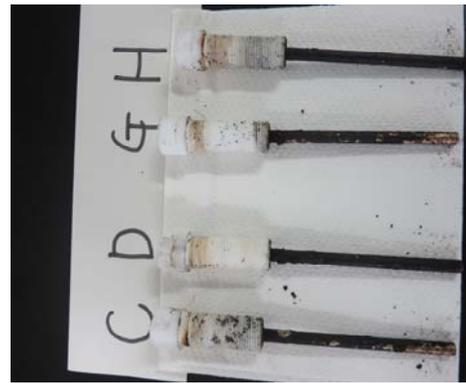
図5 テストピース(アルミニウム合金 低温側)
