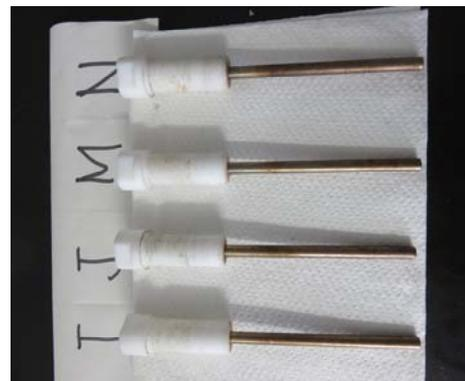
図6 テストピース(SUS304・SUS316 高温側)
