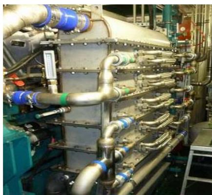
図9 新しく開発したガス冷却用熱交換器
