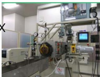
湿式-超高压微粒化装置
