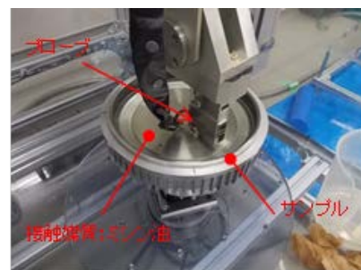
図10 鋳鉄-アルミ鋳ぐるみ品の超音波探傷状況
