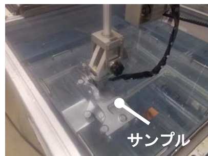
図7 アルミニウム鋳造品の探傷状況
