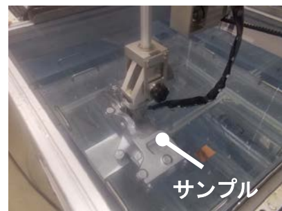
図7 アルミニウム鋳造品の探傷状況
