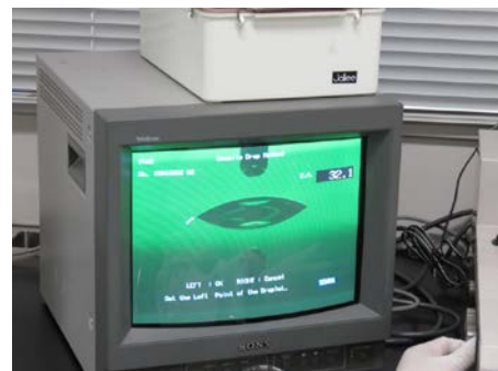
図5 評価試料の接触角画面表示(机上型)
