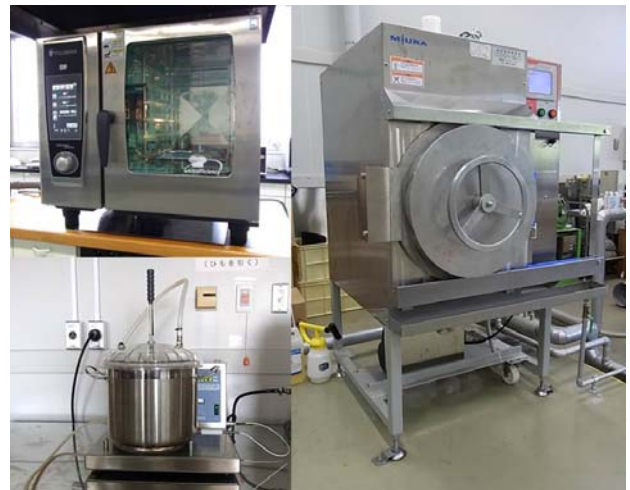
図1 スチコン(左上)と飽和蒸気調理機(右)および減圧加熱調理機(左下)
