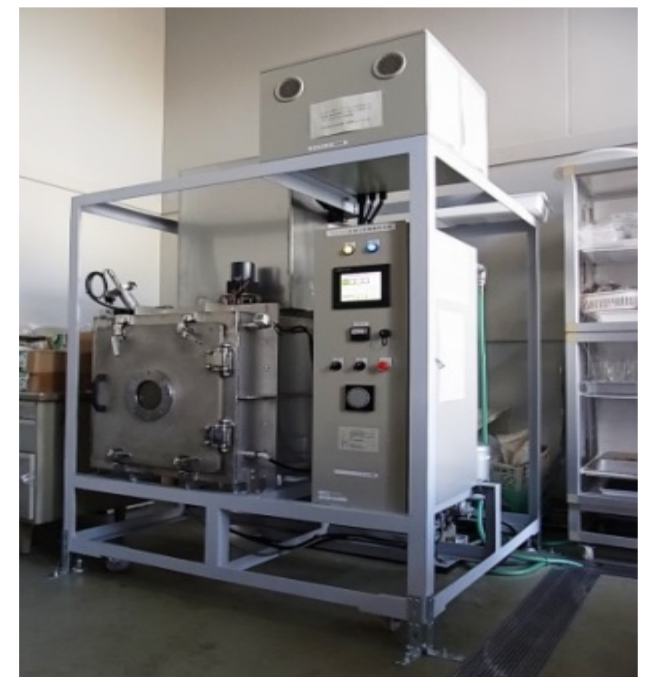
図1 マイクロ波減圧乾燥機 (西光エンジニアリング(株)製MVD-LAB)
