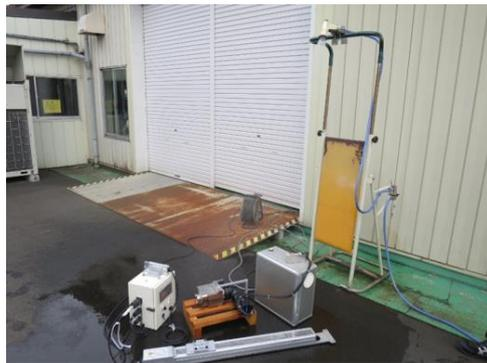
図12 電気部品の散水試験の様子
