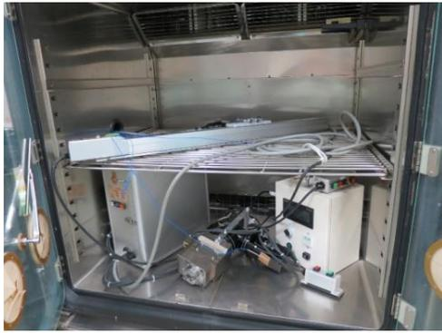
図11 恒温槽による温度サイクル試験の様子
