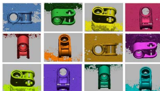
図2 12方向からの3次元画像計測データ
