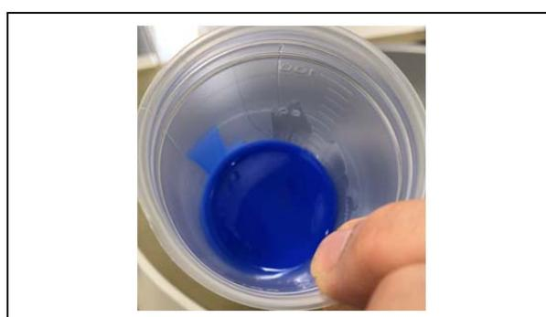
図4 着色A剤と無着色B剤を自転・公転ミキサーで3kPaの真空中で公転2000rpm自転1000rpmで3分間攪拌・脱泡した後の様子
