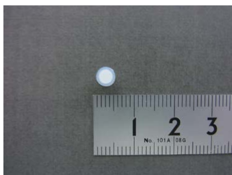
図 6 磁化曲線の測定試料
