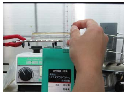
図5 寒天平板培地上に塗抹した大腸菌にプラズマクラスターイオンを送風暴露している様子
