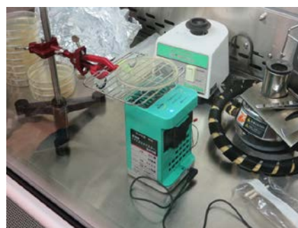
図1 大腸菌を塗抹した寒天培地の入ったシャーレーとプラズマクラスターイオン送風装置の位置関係
