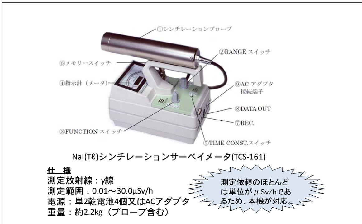
図3-15 現在の放射線量測定に使用している装置
