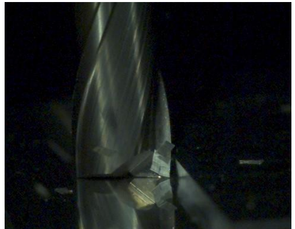
撮影例(切削加工時における工具先端部) 撮影速度: 18000FPS 画像サイズ: 512 × 384
