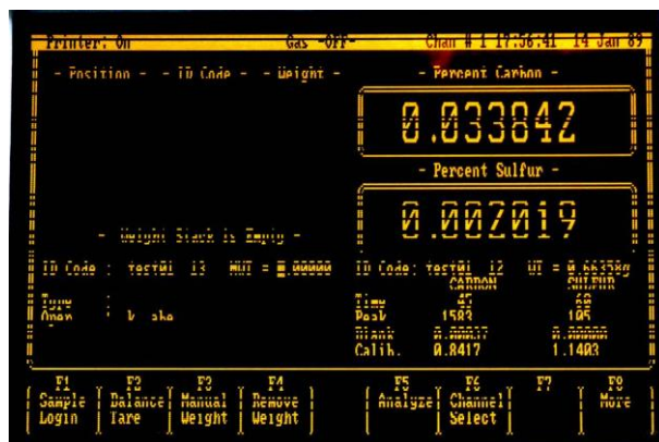
鉄鋼中における炭素と硫黄の定量分析結果（画面）
