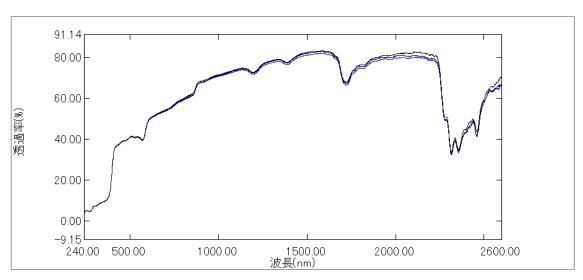
異なる3日について、同一試料を同一条件(積分球透過)で測定した結果。
