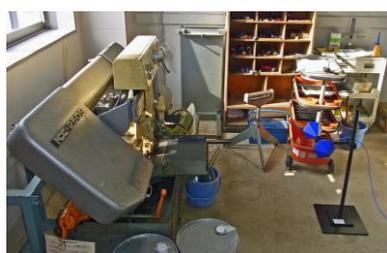
図 4-11 ノコ盤のノイズ測定風景
