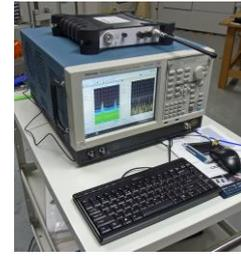
図 4-29 リアルタイムスペクトラムアナライザ (Tektronix RSA5126B)
