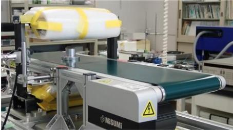
図 2-1-9 コンベヤを一体化した検査装置プロトタイプ(開口幅 250mm の小型装置)
