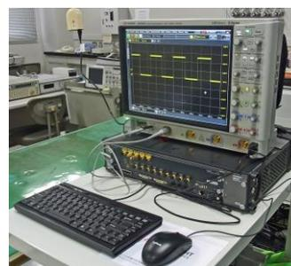
図 4-25 高周波任意波形発生装置 (Keysight M8190A)
